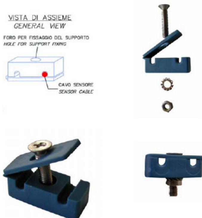
Esempio di clip di fissaggio
